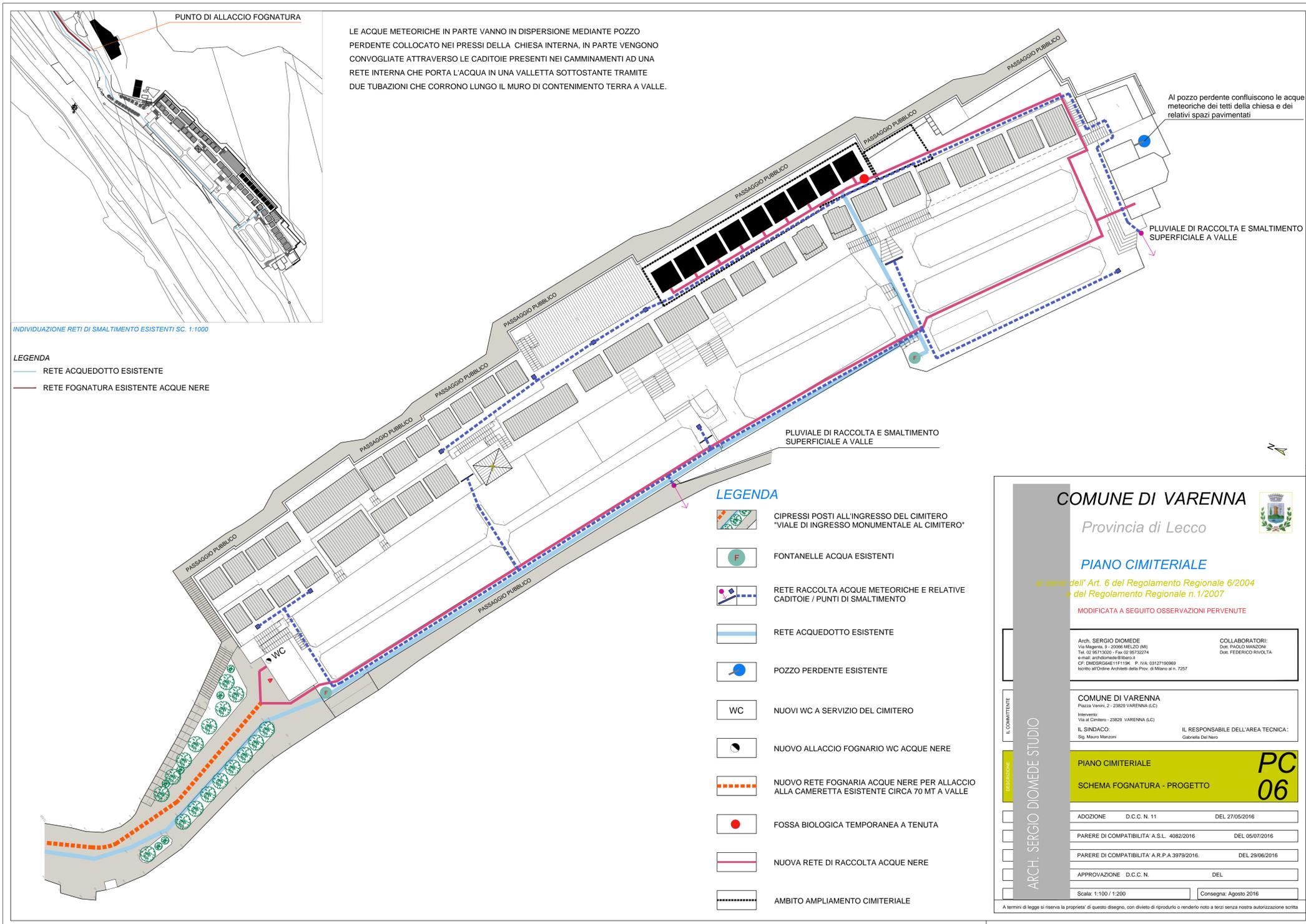
LE ACQUE METEORICHE IN PARTE VANNO IN DISPERSIONE MEDIANTE POZZO PERDENTE COLLOCATO NEI PRESSI DELLA CHIESA INTERNA, IN PARTE VENGONO CONVOGLIATE ATTRAVERSO LE CADITOIE PRESENTI NEI CAMMINAMENTI AD UNA RETE INTERNA CHE PORTA L'ACQUA IN UNA VALLETTA SOTTOSTANTE TRAMITE DUE TUBAZIONI CHE CORRONO LUNGO IL MURO DI CONTENIMENTO TERRA A VALLE.
